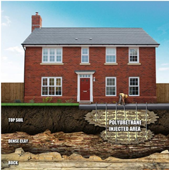
GeoTek LV представляет собой низковязкий однокомпонентный полиуретан, основанный на МДИ в комбинации с эфирами полиолов и катализаторами на основе аминов. Материал является гидроактивным и реагирует при контакте с водой, формируя, по окончании реакции, жесткую пену.
