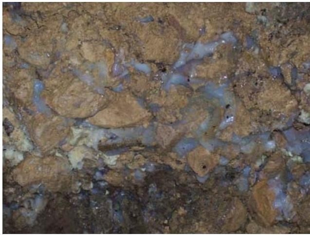
TamAcryl 2000 представляет собой смесь акриловых полимеров, применяемых в сочетании с ускорителем и катализатором реакции. После смешивания данных компонентов, в процессе реакции, образуется водонепроницаемый гель.
