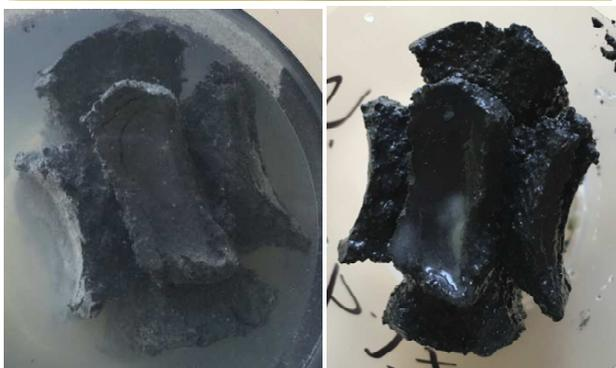
TamSeal BBR представляет собой гидрофильный уплотняющий шнур, состоящий из смеси бентонита и бутилкаучука. При контакте с пресной водой он увеличивается в объёме до 750%.
